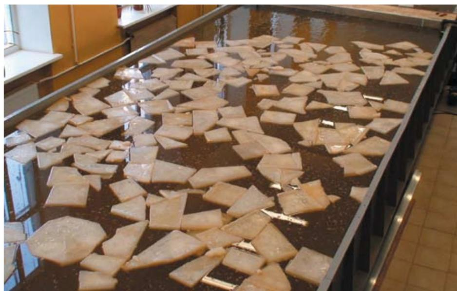
Рис. 2. Моделирование ледяного поля с помощью парафина
