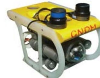
Модель СуперГНОМ. Вес 4 кг. Рабочая глубина 150 м. В комплекте с гидролокатором кругового обзора и гидроакустической навигационной системой.
