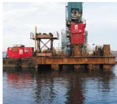
Фото 2. Вибропогружатель Müller серии MS-100 HNF. Порт г. Одесса
