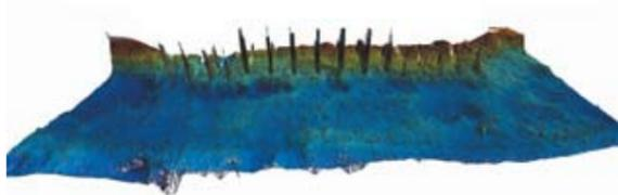
Рис. 7. Модель поверхности дна у свайного причала, исп. в целях мониторинга и освидетельствования ГТС
