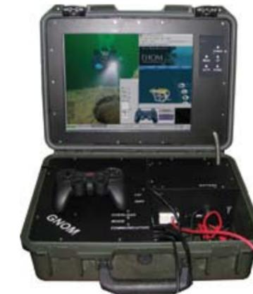
Блок управления подводными аппаратами ГНОМ. Оснащен сенсорным ЖК монитором, компьютером с различными интерфейсами, платой видеозахвата.
