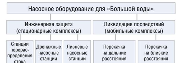
Рис. 1. Структура использования насосного оборудования в мероприятиях по защите населения, территорий и ликвидации последствий затоплений
