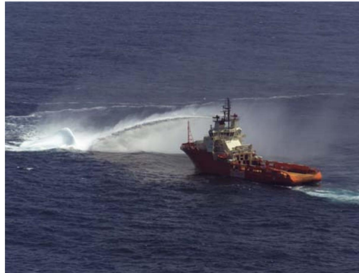
Рис. 5. Изменение траектории движения айсберга с помощью струи воды
