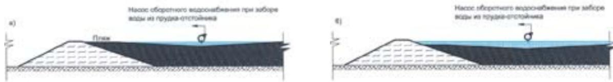
**Рис. 1. Типичное состояние хвостохранилища с пляжем (а) и без пляжа (б) при обратном водоснабжении с насосными станциями**
