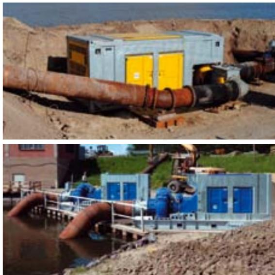
**Рис. 16.** Мобильные насосные агрегаты ВВА для предотвращения наводнений
