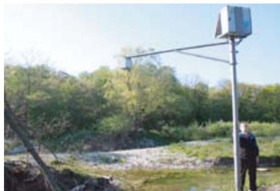
Рис. 9. Уровнемер для дистанционной передачи информации в режиме реального времени на солнечных батареях на р. Адагум (2013 г.)
