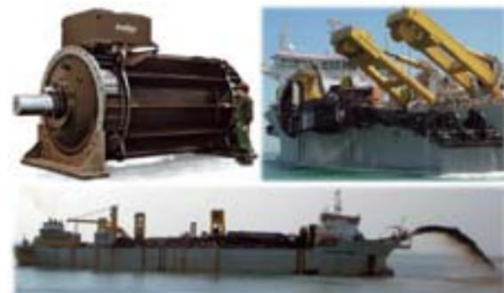
**Рис. 3.** Землесосные снаряды для намыва дамб с использованием погружных электродвигателей Ingeteam мощностью 6,5 МВт
