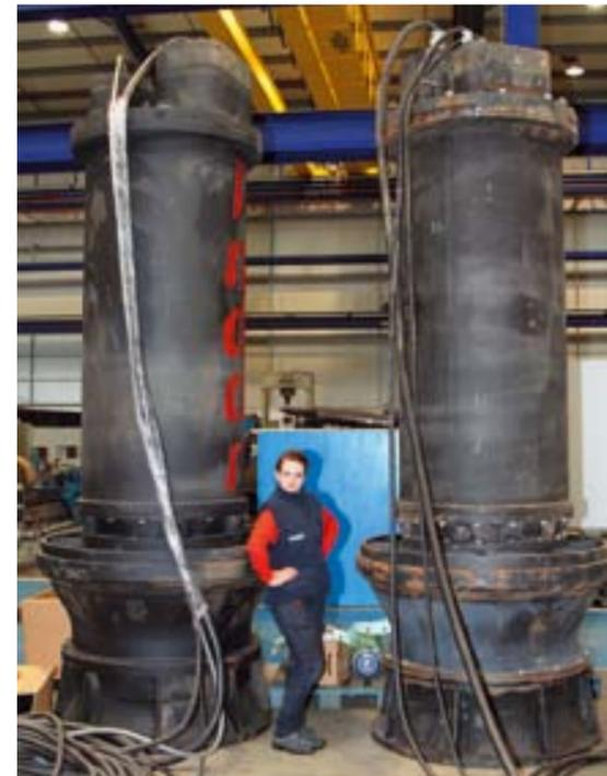
Рис. 13. Результат изготовления погружных насосов мощностью P=1,1 МВт на заводе Indar, прошедших гидравлические испытания. Рядом с насосами автор проекта — С. М. Божьева
