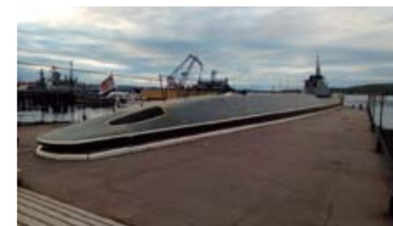
ние носовой части подлодки. Вероятно, это происходит из-за действия тех же приливов и отливов, когда массивная конструкция на «малой» воде провисает вниз, а потом, на «большой» воде, начинает водоизмещать и стремится «всплыть». Трюмы под музейной палубой неоднократно были затоплены через различные неплотности (сгнившие заклепки, донно-бортовую арматуру, коррозионные отверстия и т. п.). Создавшийся там микроклимат стал угрожать сохранности музейной экспозиции.
