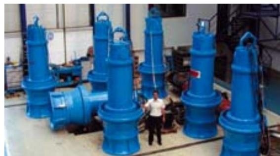
**Рис. 5.** Крупнейшие осевые погружные насосы Indar производительностью до 25 000 м<sup>3</sup>/ч
